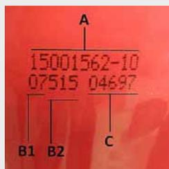
Das Herstell- bzw. Fülldatum der Feuerlöscher finden Sie auf der Behälterprägung auf der Rückseite.
