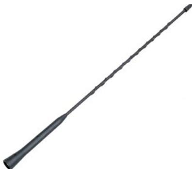
Abschraubbar, mit Kupferdraht gewendelter Stab für eine gute Empfangsqualität. Verstärkte Mastspitze zur Geräuschminderung. Innengewinde M5 mit Messing-Adapter M5/M6 und M5/M7 für optimalen Empfang.
